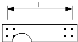
桁製作工(部材長)(鋼げた)
