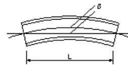
鋼橋(実仮組立時)(仮組立精度(主桁、主構のそり))
