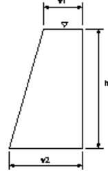
現場打擁壁工(1)
