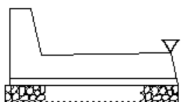
側溝工(L型側溝)
