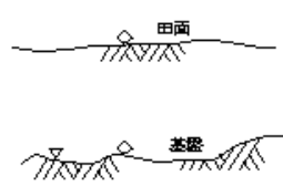
整地工(基盤整地)(表土整地)
