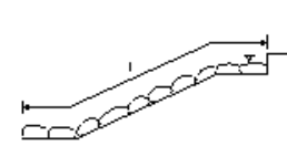
多自然型護岸工(巨石張り)(巨石積み)
