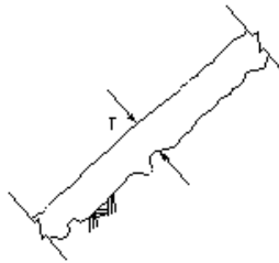
コンクリート吹付工 モルタル吹付工
