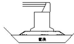
置換(床掘置換)
