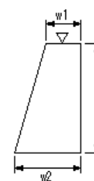
地下水遮断工_現場打擁壁工(1)
