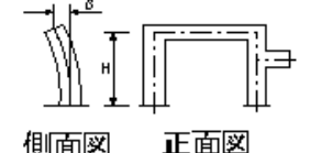
鋼製橋脚製作工(仮組立時)(柱の鉛直度)
