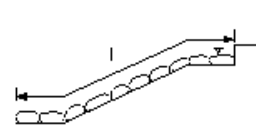
巨石張り、巨石積み
