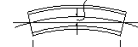
横断歩道橋製作工(検査実施)仮組立精 度<主桁、主橋のそり>
