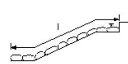
巨石張り、巨石積み
