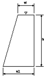
場所打擁壁工(1)
