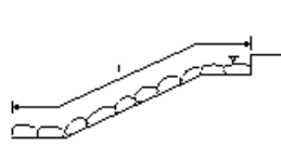
多自然型護岸工(巨石張り)(巨石積み)
