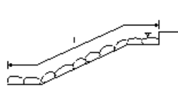
多自然型護岸工(巨石張り)(巨石積み)
