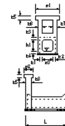
函渠工(本體工)
