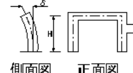
鋼製橋脚製作工(仮組立時)(柱の鉛直度)
